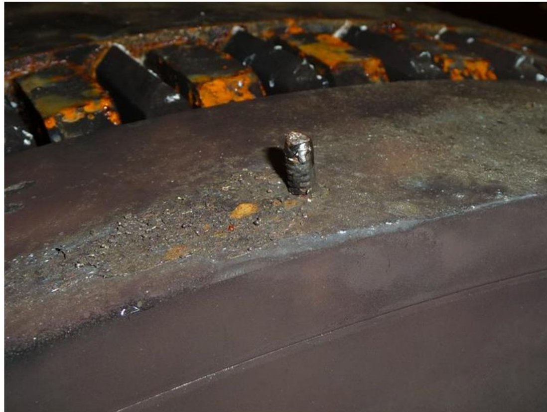
Abb. 43: Äußerer Ring des Rotors auf der Antriebsseite. Sicherungsschraube, die sich nach einiger Betriebszeit gelöst hat
