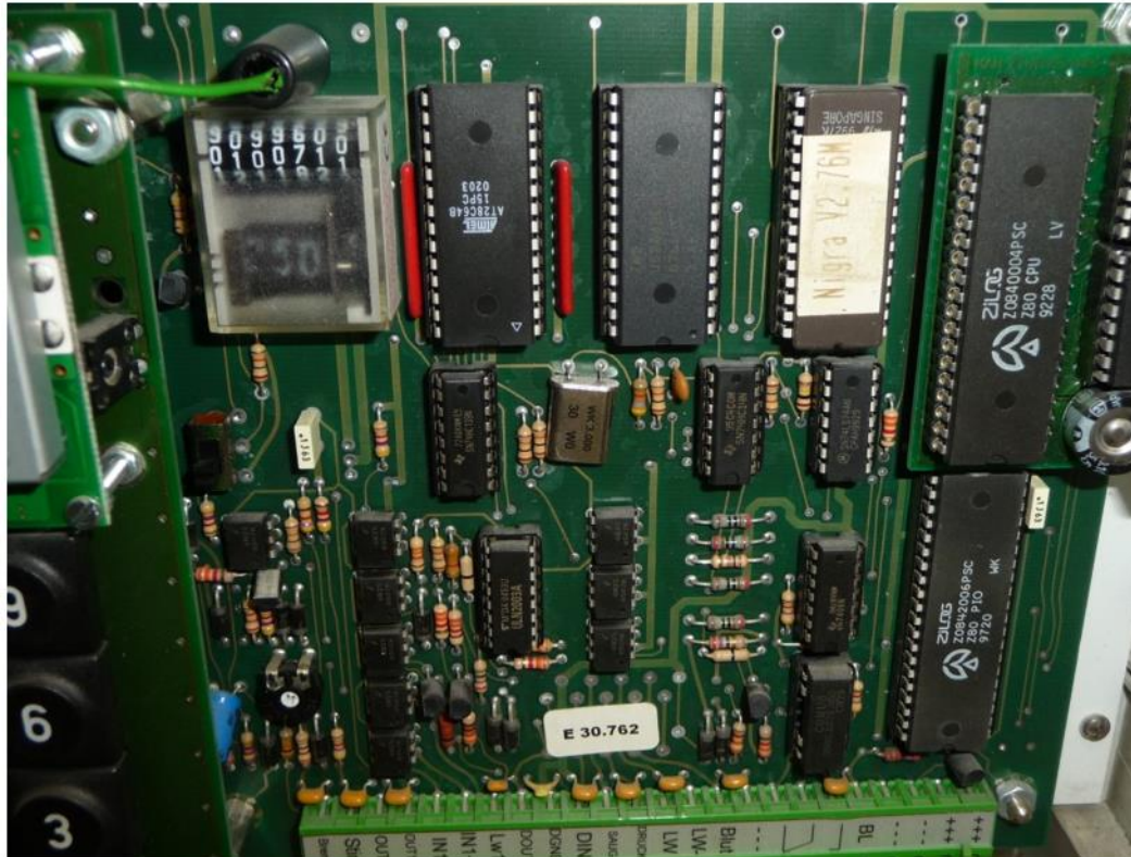
Abb. 7: Leiterplatte mit Mikrochips und Betriebsstundenzähler (100.710 Stunden)
