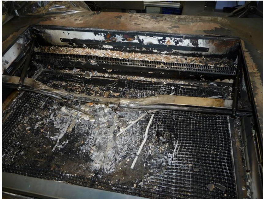
Abb. 15: Innenansicht mit Resten des Vakuumschneidens und des Lasers
