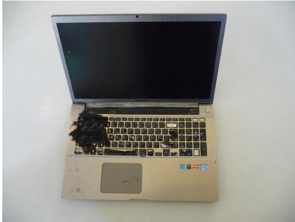
Abb. 1: Notebook Samsung 700Z mit Brandspuren
