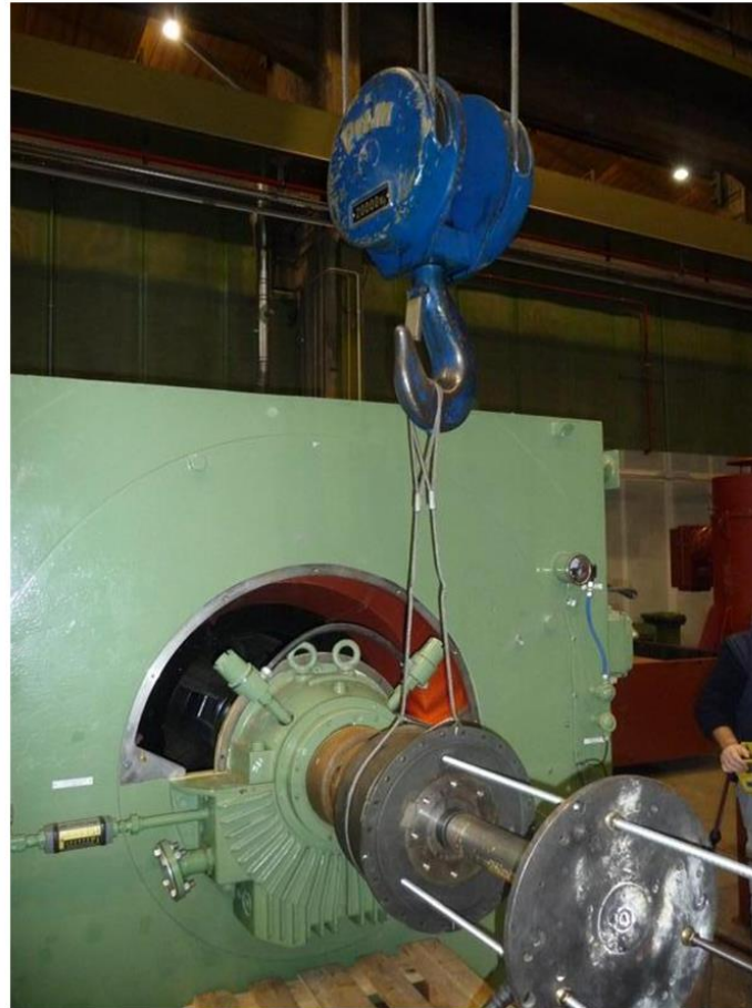
Abb. 11: Demontage der Kupplung auf der Antriebsseite
