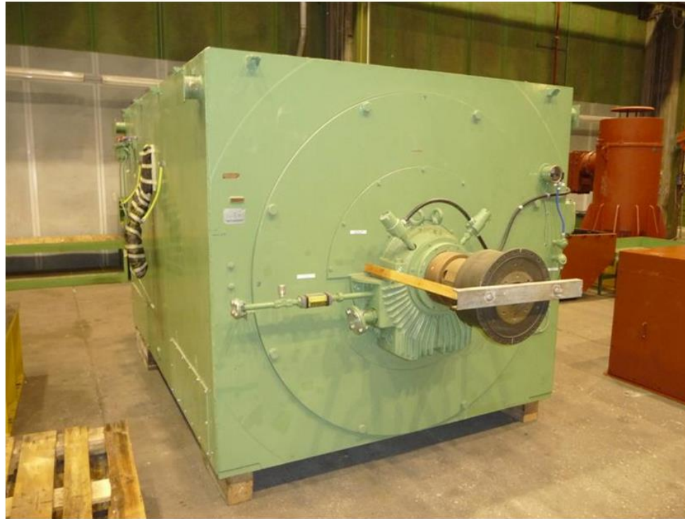
Abb. 1: Mittelspannungsmotor im Anlieferungszustand ohne Transportverpackung
